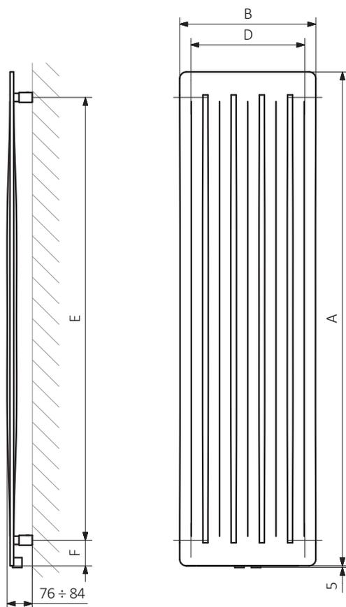
A – hauteur B – largeur C1-C5 – écartement des raccordements D – écartement des consoles en horizontal
