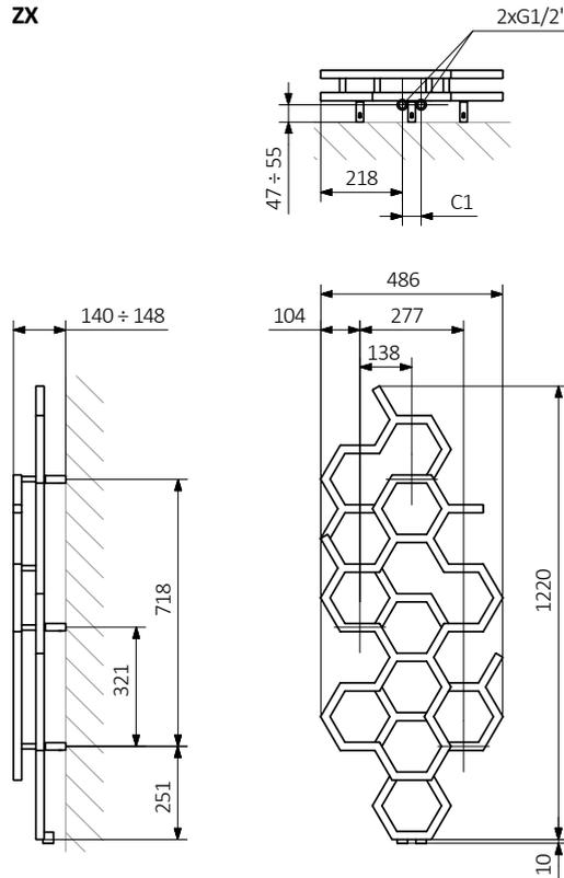
A – hauteur B – largeur C1-C5 – écartement des raccords D – écartement des consoles en horizontal E – écartement des consoles en vertical F – distance de l'axe de la console inférieure au bord inférieur du collecteur
