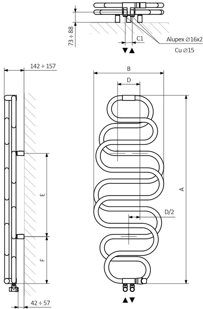
A – hauteur B – largeur C1-C5 – écartement des raccordements D – écartement des consoles en horizontal
