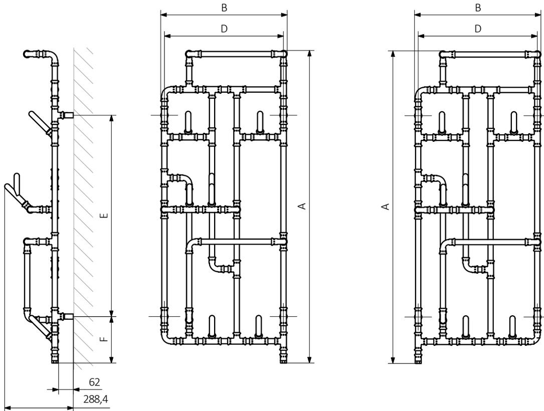
A – hauteur    B – largeur    C1-C5 – écartement des raccordements    D – écartement des consoles en horizontal    E – écartement des consoles en vertical    F – distance de l'axe de la console inférieure au bord inférieur du collecteur
